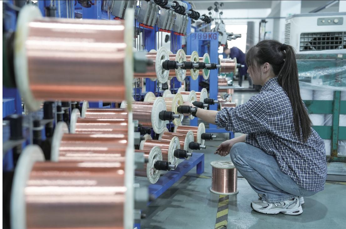
经铜丝经挤塑、绝缘包裹、组装测试等环节,制成不同成品线束……这些天,位于绍兴市柯桥区柯岩街道的绍兴一叶电子股份有限公司生产车间内,多条生产线满负荷运转。
