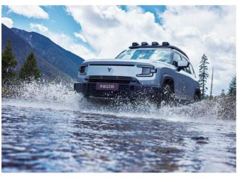
动力方面,深蓝G318将搭载增程式动力 系统,1.5T涡轮增压发动机可输出最大功率 150马力,并分为单电机和双电机两个版本, 其中单电机版最大功率为185kW,峰值扭矩 310N·m;前后双电机四驱版车型,前、后电机 最大总功率为316kW,峰值扭矩572N·m。
