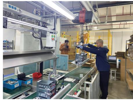
图为恒强智能提升设备,其能轻松且精准地拿起600公斤的货物,操作者双手可无阻力地自由提升或下降重物,可以轻松完成重物的搬运、吊装等作业。
