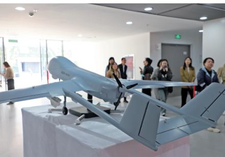
图为天目山实验室的“长鹰E无人机”。该无人机长达40h的续航时间可以使其在几千公里的半径内,全天候地进行巡航和侦察,适于执行反恐、边境巡逻以及陆地和海域侦察等任务。
