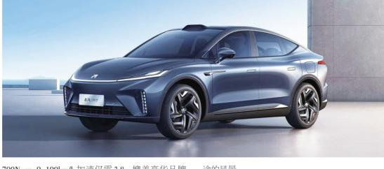
700N·m, 0~100km/h 加速仅需 3.8s, 媲美豪华品牌 性能车型的动力水准。在高速环岛科目中,转向电 机双路备份,在极端转向环境下依旧保证50%的力 矩输出,维持智驾辅助功能的正常运作。而云感座 椅作为更适合亚洲体型的一体式运动座椅,兼顾运 动风格与乘坐舒适,即使在激烈驾驶中也能给用户 带去出色的包裹感与支撑力,让驾驶更自信。
