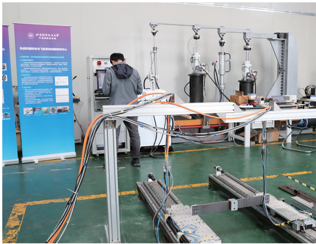
图为该院研究人员正在进行抗污染高速开关阵列压力伺服阀技术研发
