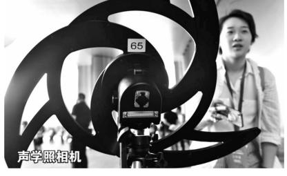
谛声科技的声学照相机在双创活动周期间发布,这也是国内首款自主研发的声学相机设备之一。该产品通过前端声音采集+后端人工智能匹配算法,使噪声信息和视频信息有机结合,能够对稳态、瞬态以及运动声源进行快速识别定位,帮助人们直观地认识声波、声场和声源,了解机器设备产生噪声的部位和原因,进而寻找治理噪声、控制噪声的途径。 本报记者 林洁
