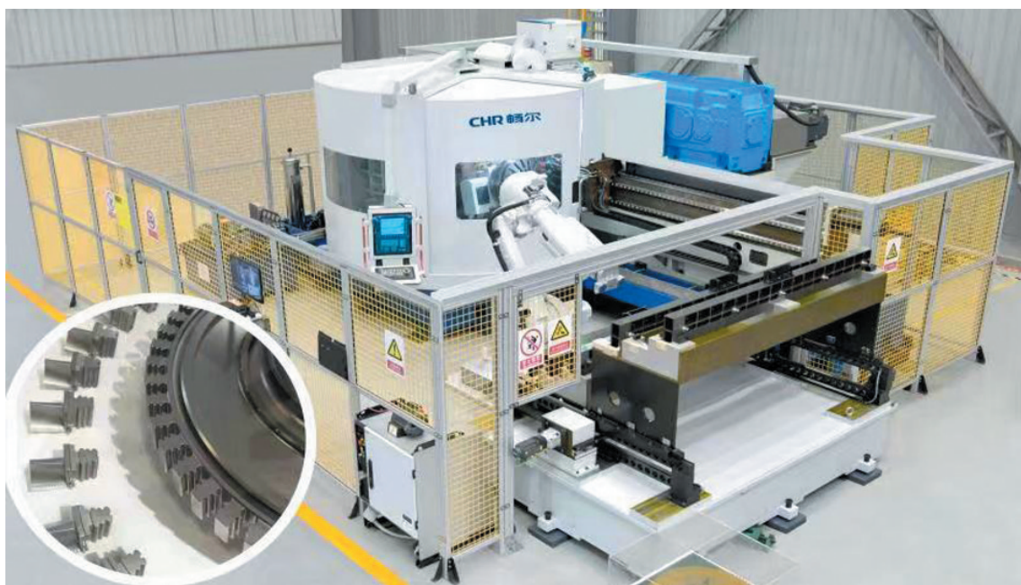
一代飞机发动机榫槽加工四轴数控卧式侧拉床
