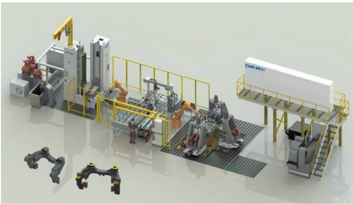
多机器人协同汽车制动钳支架加工自动线
