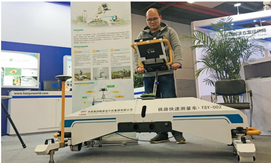
图为展览会现场展示的铁路快速检测车,该车能为地铁做过隧道三维扫描
