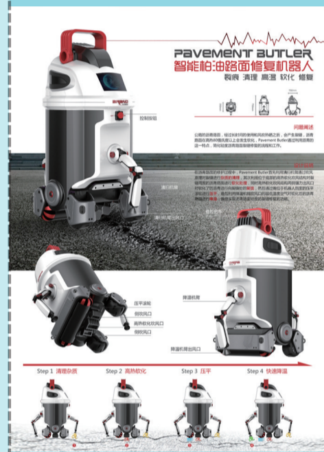
智能柏油路面修复机器人
