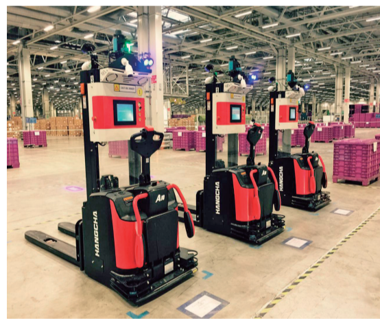
杭叉集团股份有限公司通过自主研发,成功掌握无需反光片的激光环境导航技术、底盘驱动技术及全方位安全防护技术等关键技术,开发出国内先进的无轨化激光导航叉车系AGV,实现叉车等传统工业车辆自动化、智能化改造。
