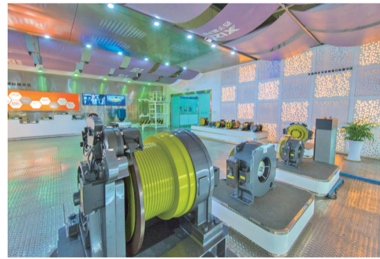
浙江西子富沃德电机有限公司自主研发的高速永磁无磁传动电机,突破了国外品牌长期垄断局面。
