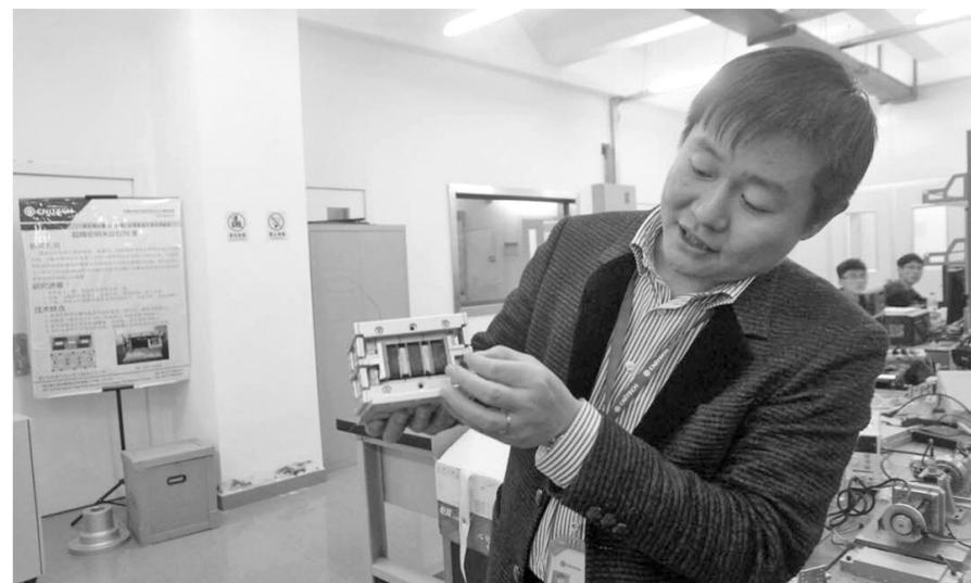
图为张驰在实验室向记者介绍宏微操作机器人平台的纳米级定位音圈电机。
