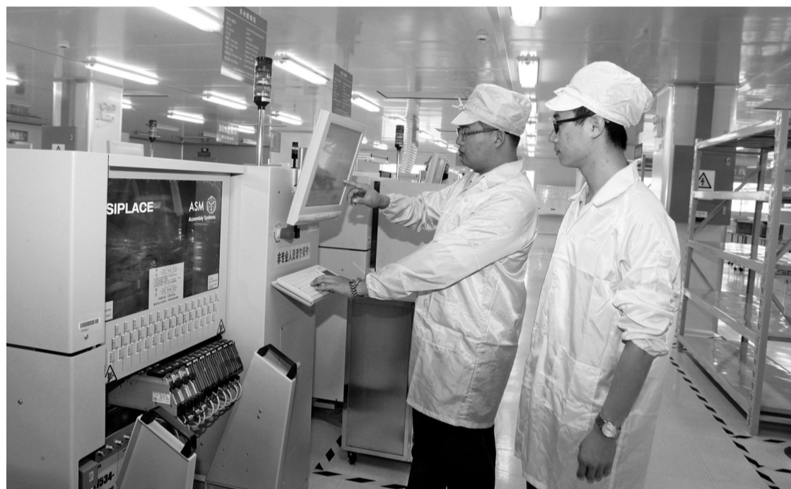
图为花园金波公司SMT(表面组装技术)事业部第一条生产线安装调试完毕,工作人员正在试生产各种芯片集成板。
