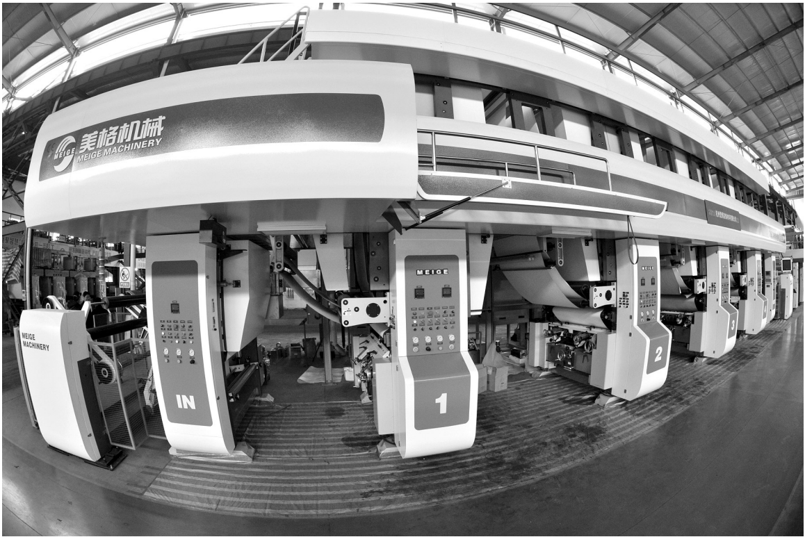
图为“美格”生产的320米/分装饰纸全伺服自动凹版印刷机。
